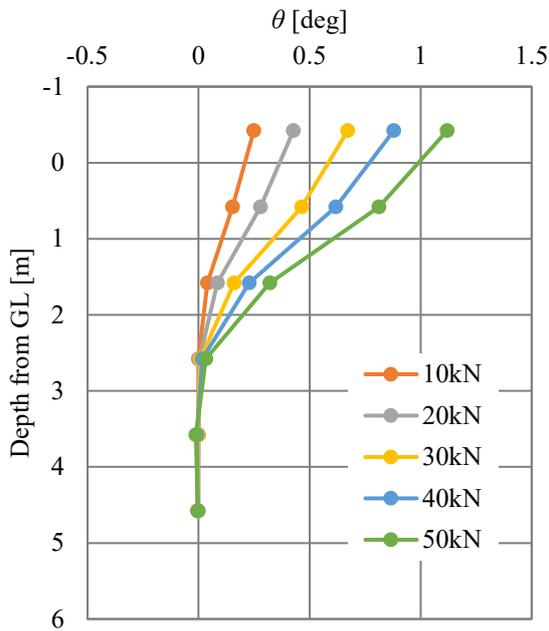
Fig. 12 Measurement values of inclinometer
