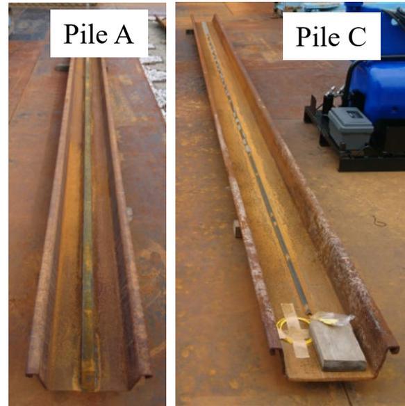
Fig. 3 Test piles
