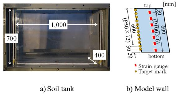
**Fig. 2** Model test apparatus
